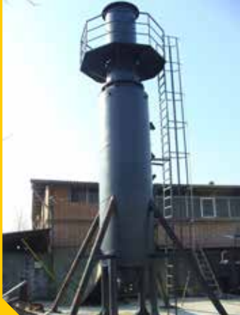
طراحی و ساخت بستر آزمون برای تست مشعل‌های پالایشگاه و پتروشیمی آبادان
