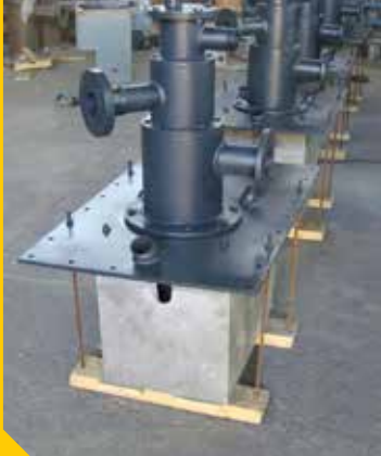
▲ ساخت و بومی‌سازی مشعل گندله‌سازی شرکت گل‌گهر سیرجان (آبان ۱۳۹۳)
